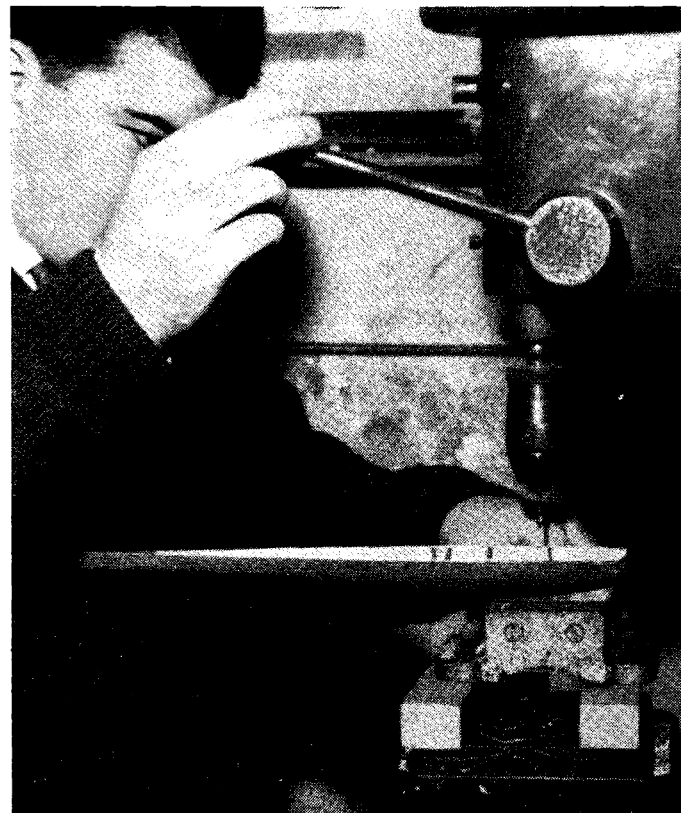
La foratura si esegue al trapano a colonna, regolato ad alta velocità, fissando il pezzo in morsa mediante l'apposita flangia di cui è dotata la fusione. Si deve fare attenzione alla profondità del foro.
